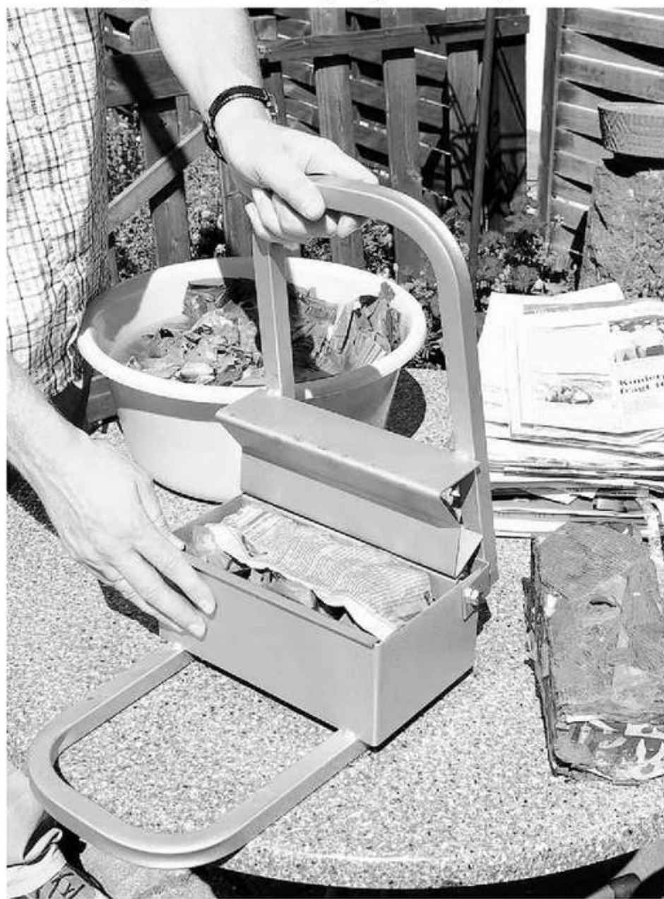
Einfach in der Handhabung, in vielen Geschäften zu erhalten: Mit einer solchen Brikettpresse lässt sich Altpapier für das Verfeuern im Heizofen präparieren. Allerdings ist diese Art der Wärmeerzeugung schon seit 1988 verboten, weil beim Verbrennen starke Belastungen für die Umwelt entstehen. Foto: imago/Döhrn
